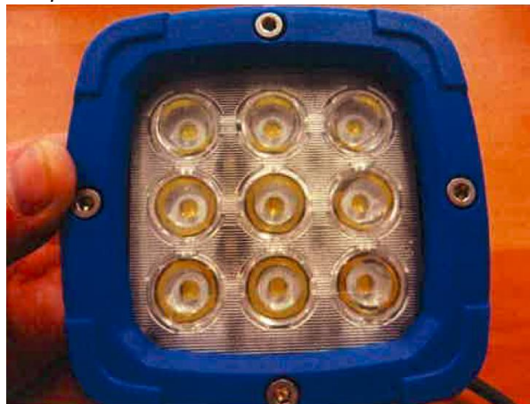
Fotografia / Photo 6 Sample after test IK 06
